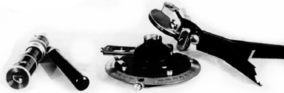
Поляризационный карманный микроскоп в разобранном виде (1947-1948 гг.)
